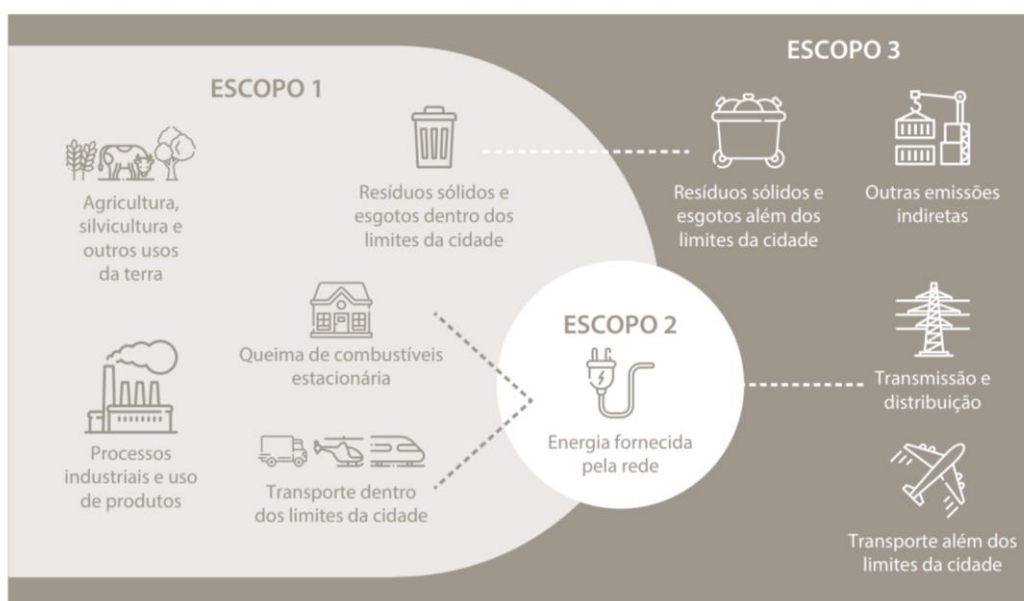
Figura 38. Escopos e fontes de emissão no método GPC. Fonte: Prefeitura de São Paulo (2021), adaptado de Global Protocol for Community-Scale Greenhouse Gas Emission Inventories, GPC (C40 Cities, ICLEI, WRI, 2014).
